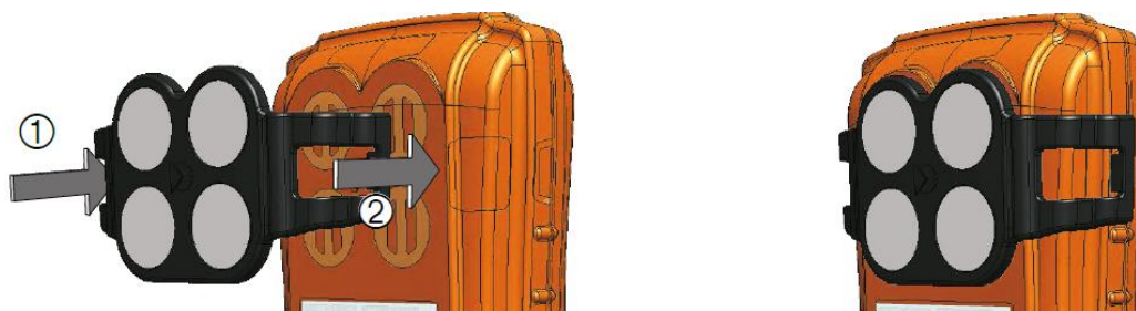
Obr. 6: Instalace externího nástavce s filtry
