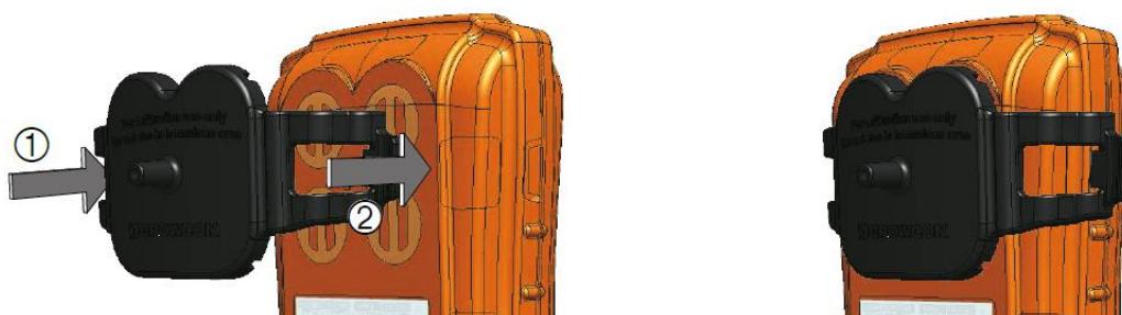
Obr. 5: Instalace kalibračního nástavce
